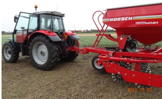
Obr. 7 Bezorebný kombinátor se připojuje za traktor
