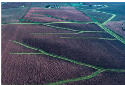
Obr. 11 Stabilizace drah soustředěného povrchového odtoku – zatravnění údolnic
