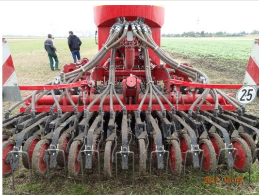
Obr. 9 Bezorebný kombinátor – závěrečná část zajišťující uzavření drážky po zasetí semen
