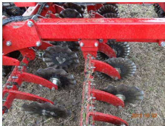
Obr. 9 Disky prořezávají drážky pro zasetí semen
