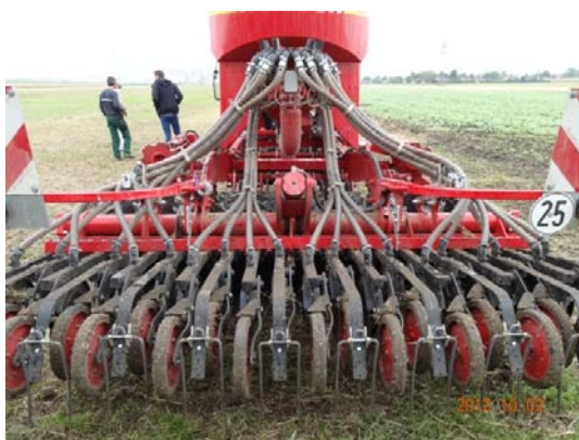
Obr. 10 Bezorebný kombinátor – závěrečná část zajišťující uzavření drážky po zasetí semen
