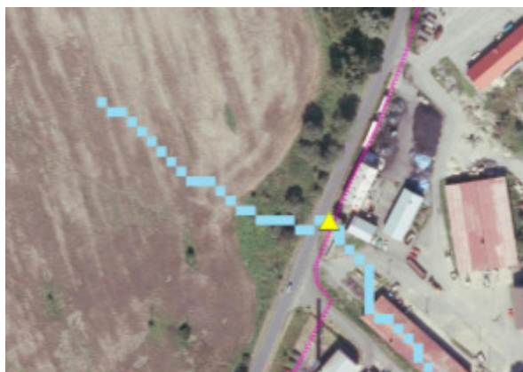
Obr. 2 Identifikace kritických bodů (žlutě) na průsečíku údolnice (modře) a hranice zastavěného území obce dle územně analytických podkladů KÚKK (růžově)
